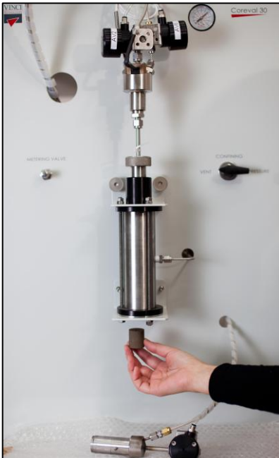
מערכת Coreval 30 למדידת פורזיטי ופרמיאביליטי (Vinci technologies)
