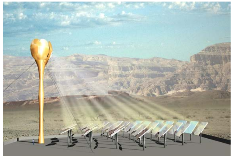
איור 2 - מגדל מרכזי (Central Receiver), מתוך הדמיה של חברת AORA, מהמתקן בקיבוץ סמר
