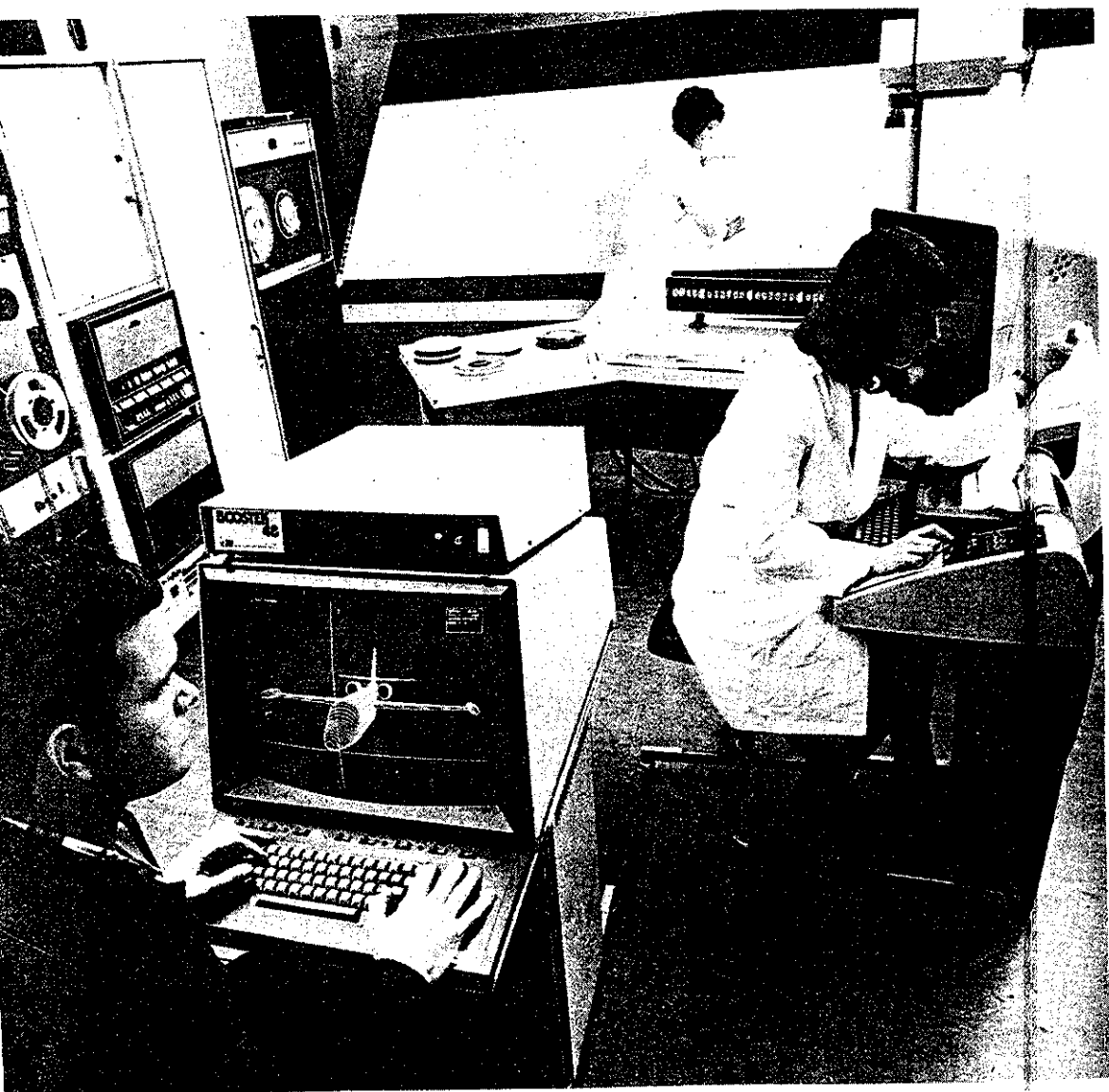
ציור מספר 42: מערך תיב"ם מתוצרת עצמית בתעשייה האווירית (תיב"ם - תיכון וייצור בעזרת מחשב)
